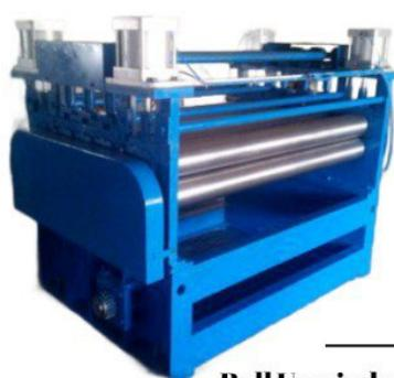
دستگاه رول بازن دستگاه رول بازن برای صاف کردن ورق های رول شده در عرض و ضخامت های مختلف ساخته می شود این نوع دستگاه از ۵ غلطک تا ۲۲ غلطک طراحی و ساخته می شود بیشتر ساخت این دستگاه ها به صورت هشت غلطک ساخته می شود و به صورت مکانیک و هیدرولیک و دستی قابل تنظیم هستند و قدرت صاف کردن رق را تا ضخامت های ۲۵ میلیمتر را دارند و کاربرد زیادی در صنایع فولاد دارد
